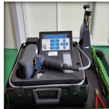
SF6 Leak Detector (Q-200)
