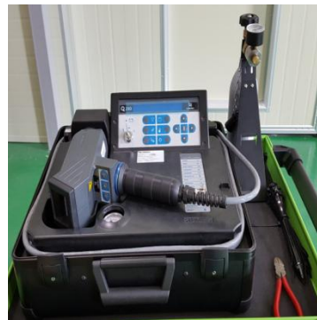
SF6 Leak Detector (Q-200)
