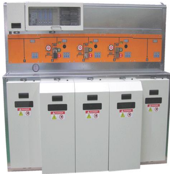
RMU 12~24kV, 630A 12.5~20kA, 50Hz
