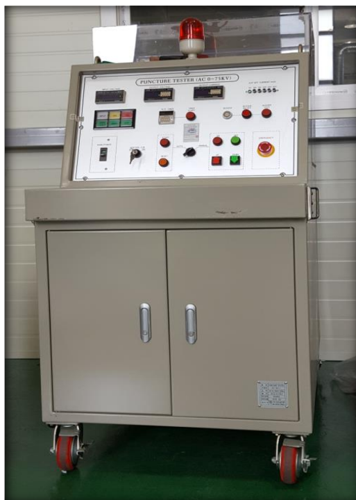
내전압 시험기 (75kV 300mA 22.5kVA)
