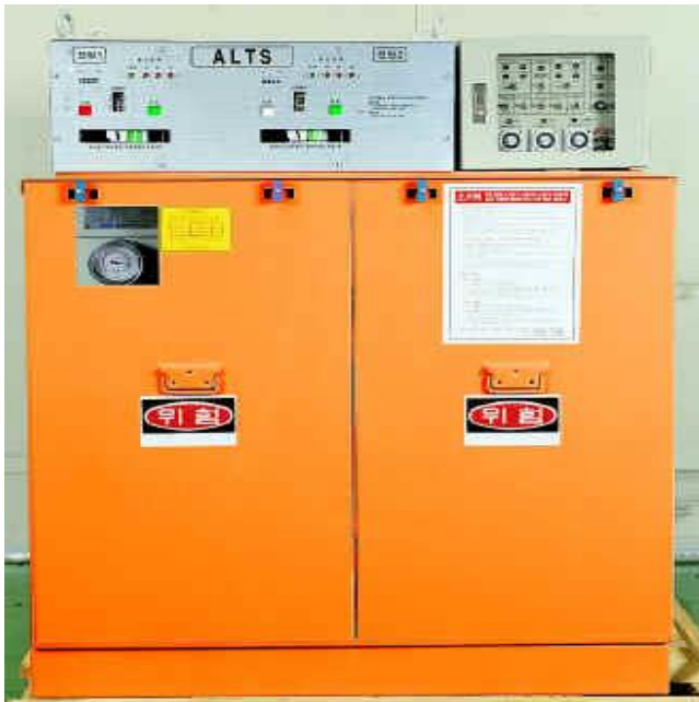
자동부하전환개폐기 (ALTS) 25.8kV, 630A, 12.5kA, 60Hz
