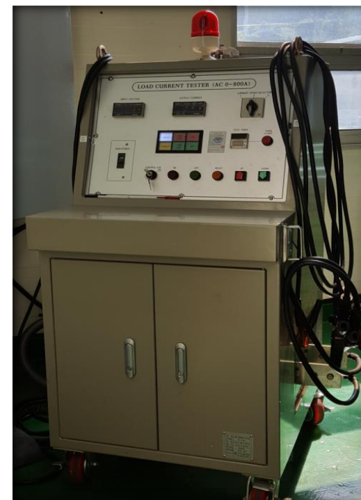
단상전류 발생기(800A 10V 8kV A)
