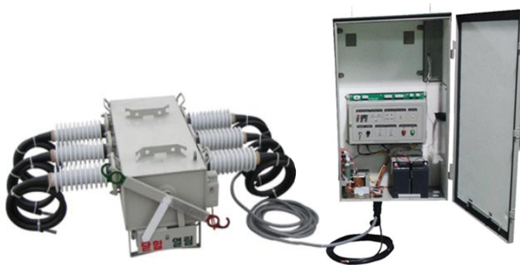
가스절연부하개폐기 (PGS) : 몰드콘Type 12~36kV, 400/630A 16kA, 50/60Hz
