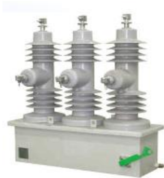
폴리머 리클로저 (REC) 25.8kV, 630A 12.5kA, 60Hz
