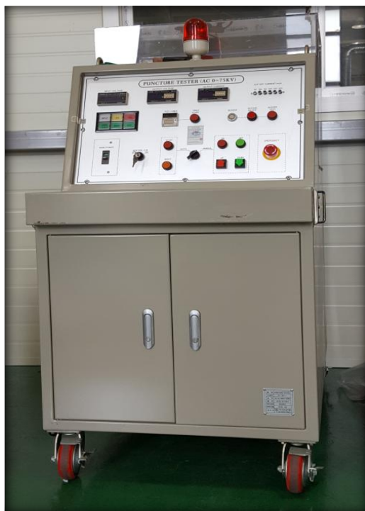
내전압 시험기 (75kV 300mA 22.5kVA)
